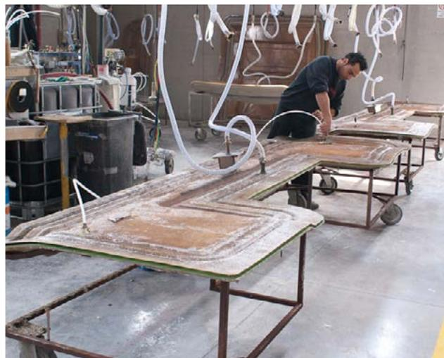
Rivestimenti e arredi dell'ambulanza realizzati in materiale composito, stampati all'interno dello stabilimento con tecnologia RTM
