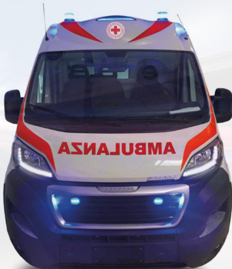
Lampeggianti 8 Led effetto flash a profilo ribassato, funzione di stazionamento, conformi alla norma ISO4140 - IP66 - omologati ECER65, insensibili a vibrazioni e umidità.
